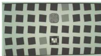
Рисунок 6 – Тестовый шаблон качества изображения на доступном датчике изображений на базе CMOS
