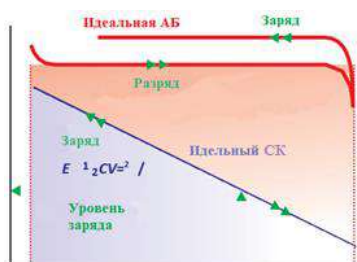
Рисунок 3 – Во время разрядки напряжение на ячейке идеальной литий-ионной батареи остается постоянным, а напряжение на идеальном электрическом двухслойном конденсаторе убывает линейно.
