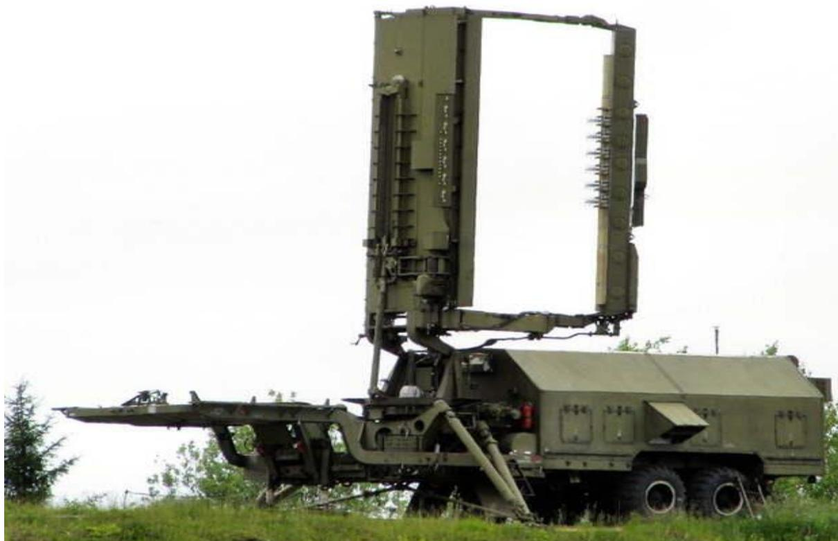
Рис. 7.1. Полуприцеп 6УФ
