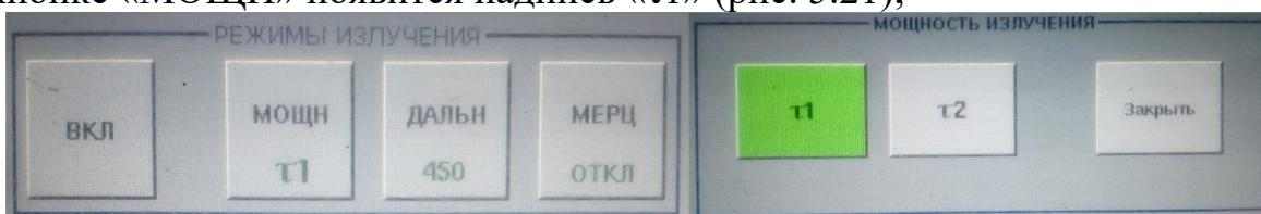
Рис. 5.20. Включение мощности передатчика «100 %» на панели МПС 12
