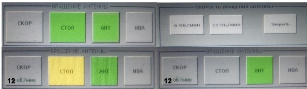
Рис. 5.37. Включение скорости вращения «12 об/мин» на панели МПС 12
