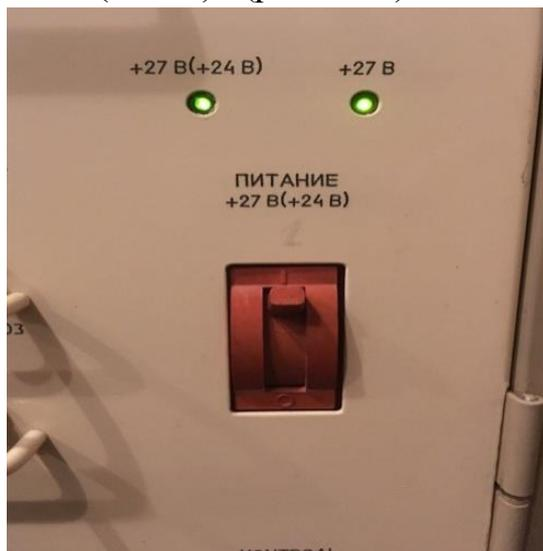
Рис. 5.16. Индикация блока 278-131-04
