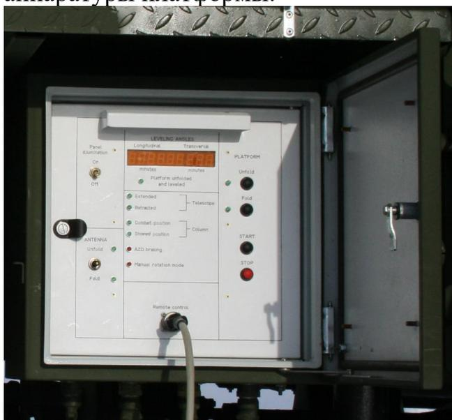
Рис. 2.5. Подключение пульта дистанционного управления к разьему «ПДУ»
