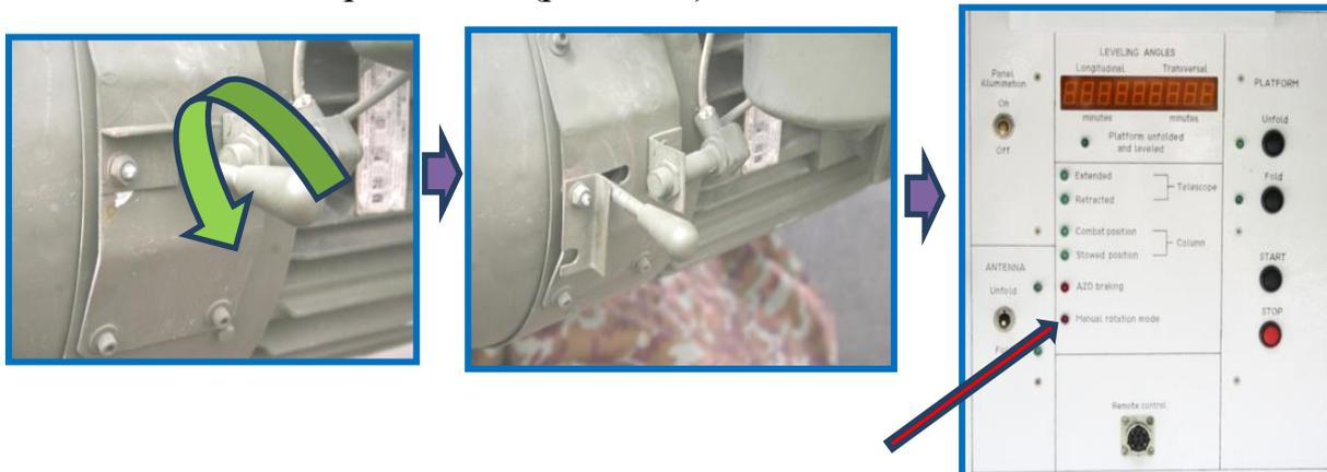
Рис. 2.16. Включение тормоза азимутального привода
