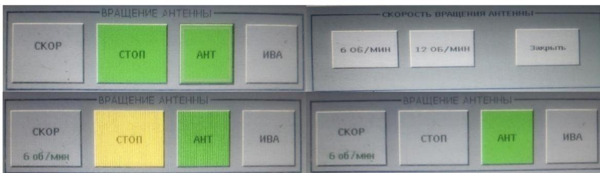
Рис. 5.19. Включение скорости вращения «6 об/мин» на панели МПС 12
