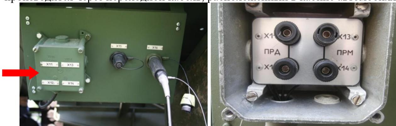
Рис. 2.24. Клеммы Х11–Х14
