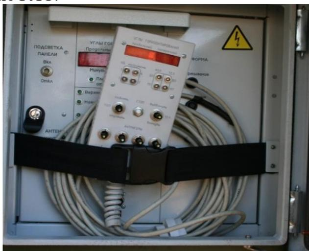
Рис. 2.12. Укладывание пульта дистанционного управления
