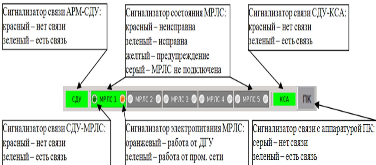
Рис. 8.14. Порядок контроля наличия связи АРМ с СДУ и СДУ с подключенными устройствами
