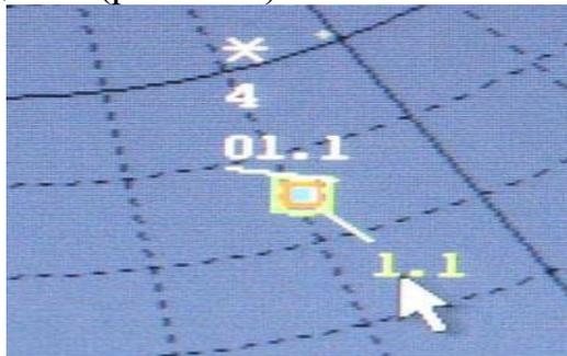
Рис. 6.43. Отображение знака сопровождения и дополнительного знака особенности сопровождения
