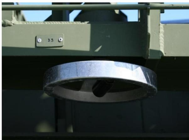
Рис. 2.8. Вращение штурвалов привода замков крайних секций антенной решетки
