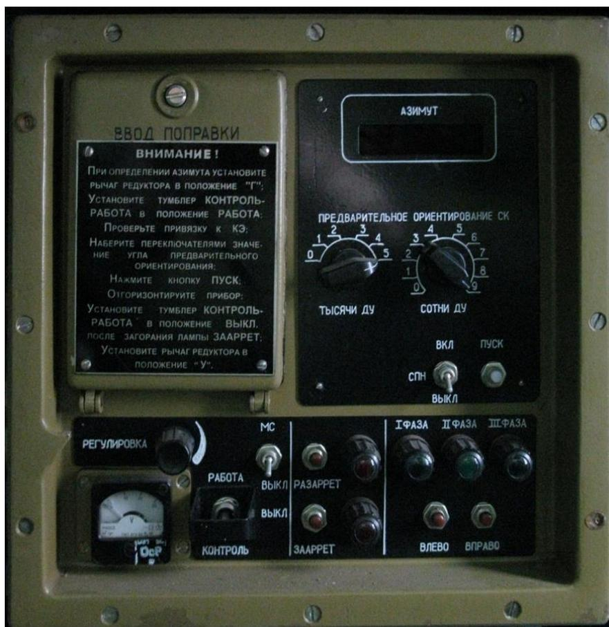
Рис. 6.7. Блок преобразования информации и управления
