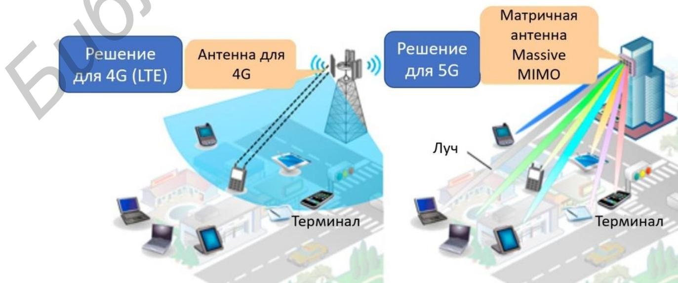
Рисунок 2 - Сравнение технологии *Massive MIMO* в сетях 5G с антеннами для сетей 4G
