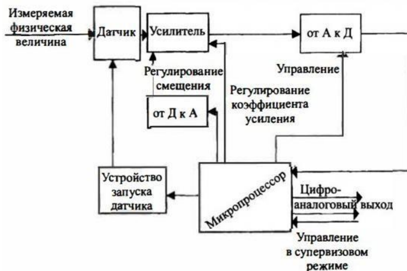
Рисунок 5 - Архитектура датчиков со встроенным микропроцессором
