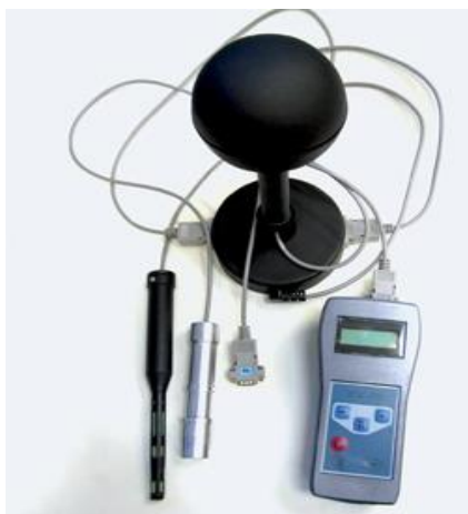
Рис. 1.8. Переносной метеометр МЭС-200А (термоанемометр)
