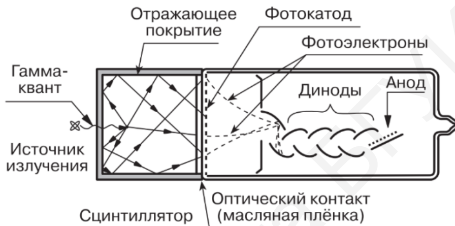
Рис. 6.2. Устройство ФЭУ
