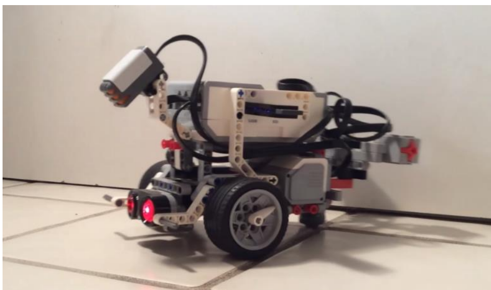
Рисунок 1 – Модель робота (аппаратная составляющая), имитирующего поведение червя
