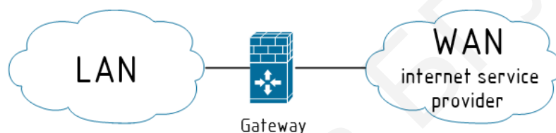
Рисунок 10 – Укрупнённая структура компьютерной сети
