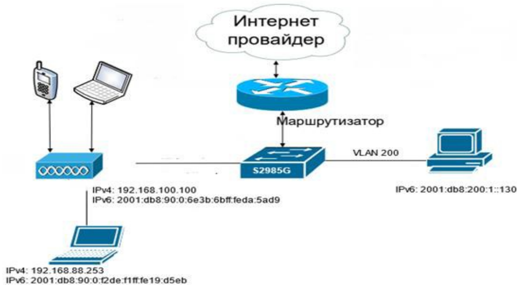
Рисунок 1 – Функциональная схема локальной компьютерной сети компании
