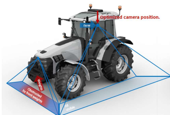
Рис. 2. Пример установки видеокamer системы кругового обзора EasyFit Fig. 2. Example of installation of the around overview videocameras EasyFit
