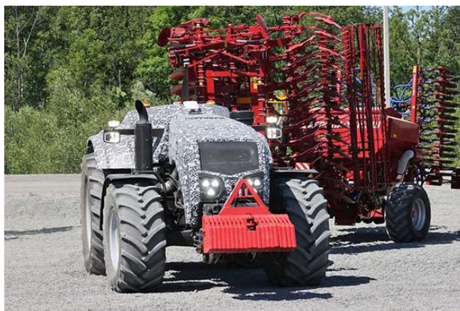
Рис. 1. Макетный образец беспилотного трактора Беларус 3523i Fig. 1. The sample of driverless tractor Belarus 3523i
