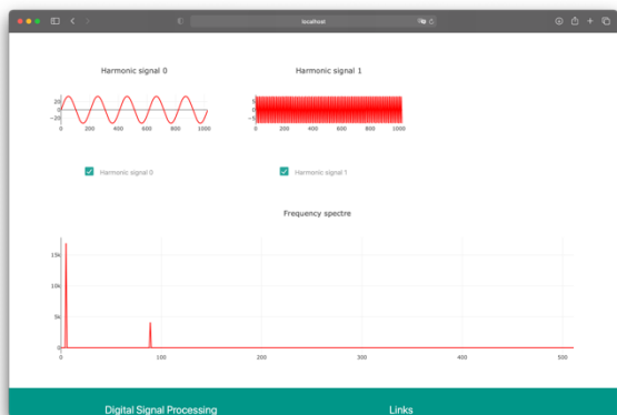
Рисунок 2 – Визуализация генерации полигармонического сигнала с преобразованием Фурье
