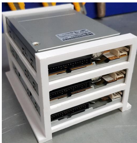
Рисунок 11 – Финальная версия стойки для флоппи-приводов
