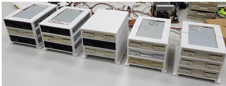
Рисунок 10 – 15 флоппи-приводов, размещенных в 5 стойках
