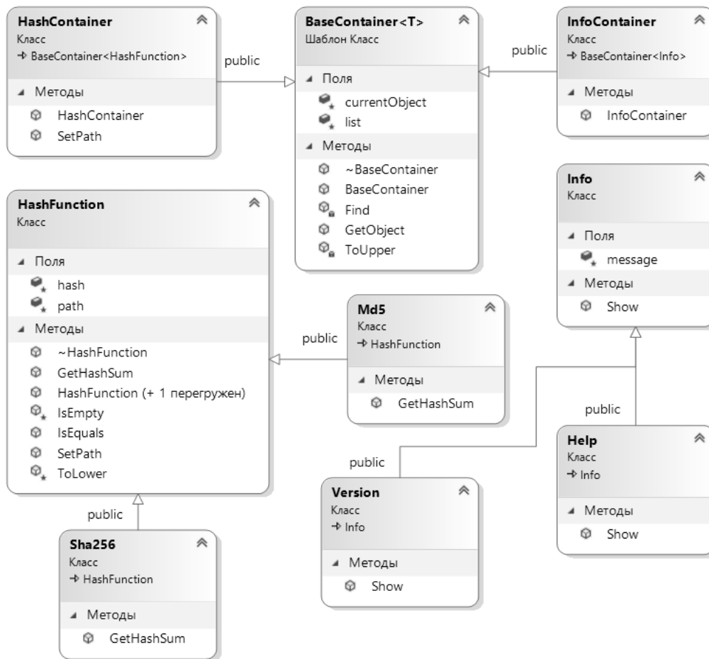
Рисунок 1 – Упрощённая диаграмма классов разработанного программного средства
