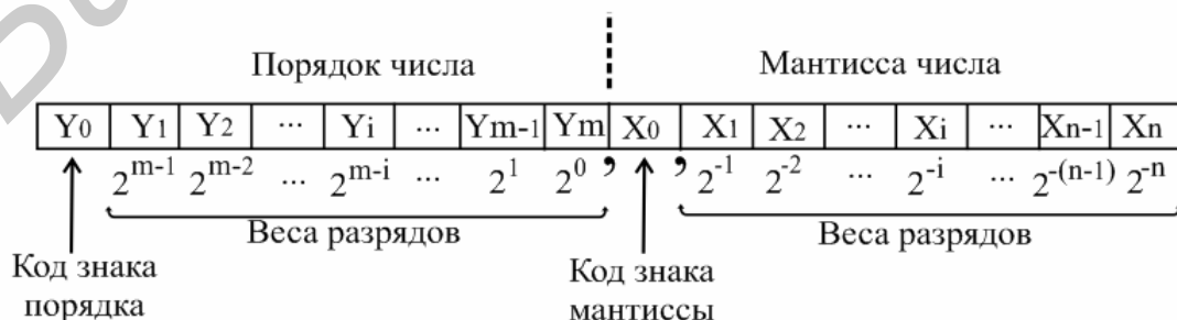
Рис. 2.4. Разрядная сетка для хранения чисел в форме с плавающей запятой
