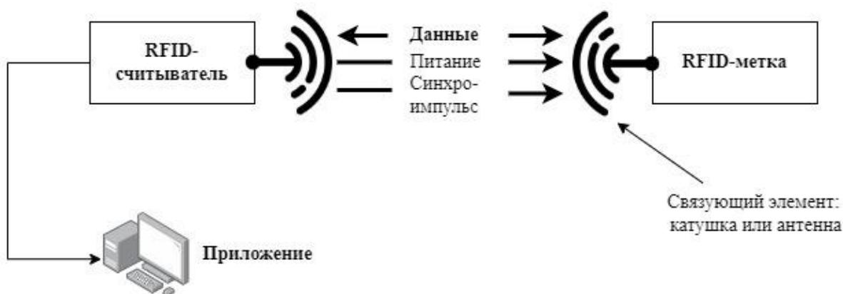
Рис.1 — Схема работы RFID-системы
