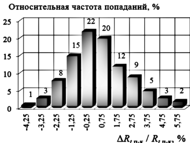
Рис. 1. Гистограмма распределения относительной ошибки \Delta R_{t,п-к} / R_{t,п-к} для оценок R_{t,п-к} , получаемых по уравнению регрессии (3)
