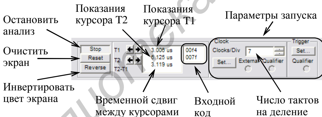
Рис. 22. Панель управления логического анализатора
