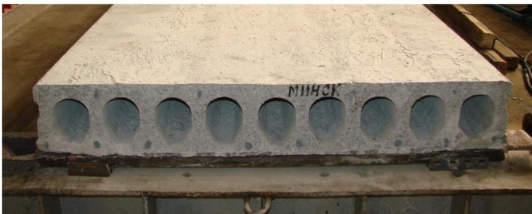
Рисунок 4.8 – Общий вид плиты и ее поперечного сечения
