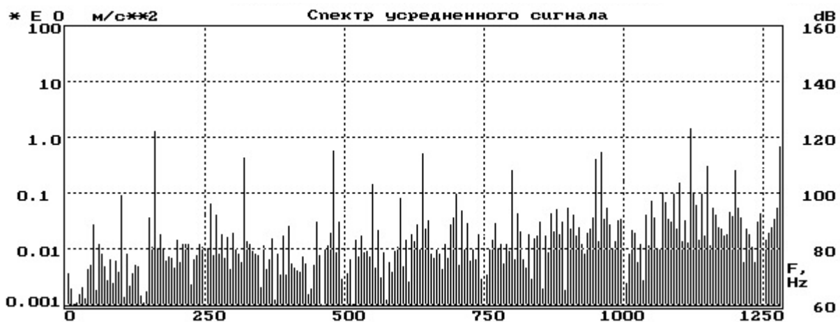
Рисунок 3.41 – Амплитудный спектр вибрационного сигнала после усреднения во временной области (ось абсцисс – частота, c^{-1} ; ось ординат – виброускорение, m/c^2 )
