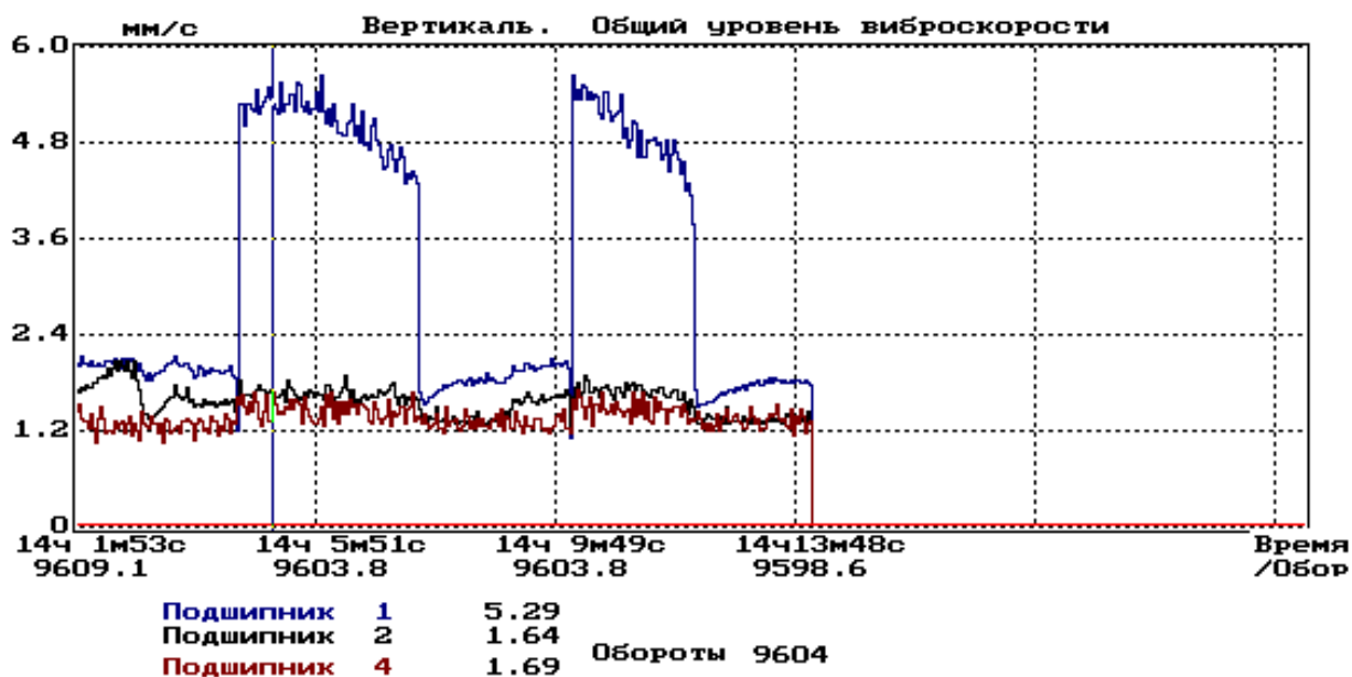
Рисунок 5.3 – Изменение СКЗ виброскорости при изменении режима работы турбодетандера
