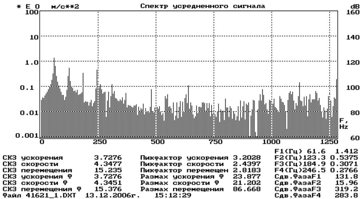
Рисунок 5.18 – Амплитудный спектр вибрационного сигнала ( m/c^2 ) ДГА для аварийно-опасного режима работы, усредненного во временной области относительно частоты 62 Гц в точке контроля вертикального направления турбины (ось абсцисс – частота, Гц)
