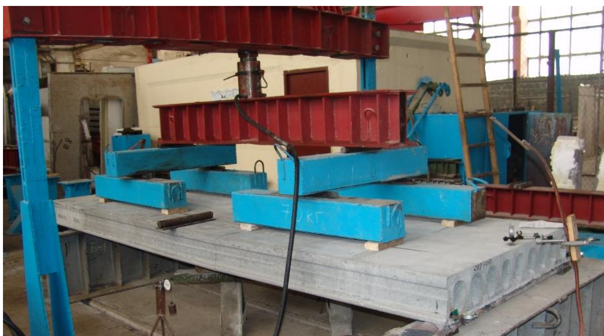
Рисунок 4.9 – Стенд для статических испытаний плит, нагружение
