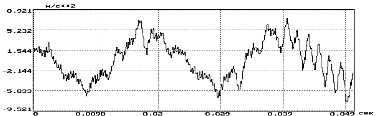
Рисунок 2.10 – Временная реализация вибросигнала в единицах виброускорения, зафиксированная при исследовании подшипниковой опоры электродвигателя, при его выбеге (ось абсцисс – время, с; ось ординат – виброускорение, m/c^2 )
