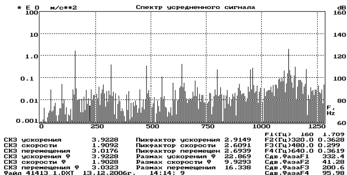
Рисунок 5.14 – Амплитудный спектр вибрационного сигнала ( m/c^2 ), усредненного во временной области относительно частоты 160 Гц, в точке контроля вертикального направления турбины ДГА для нормального режима работы, (ось абсцисс – частота, Гц)
