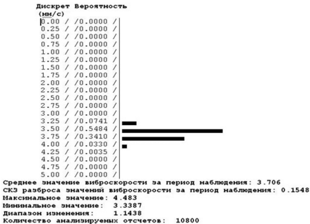
Рис. 3. Результаты обработки суточного временного тренда СКЗ виброскорости подшипника генератора при его нормальной работе
