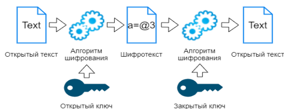
Рисунок 1 – Структурная схема работы асимметричных криптосистем
