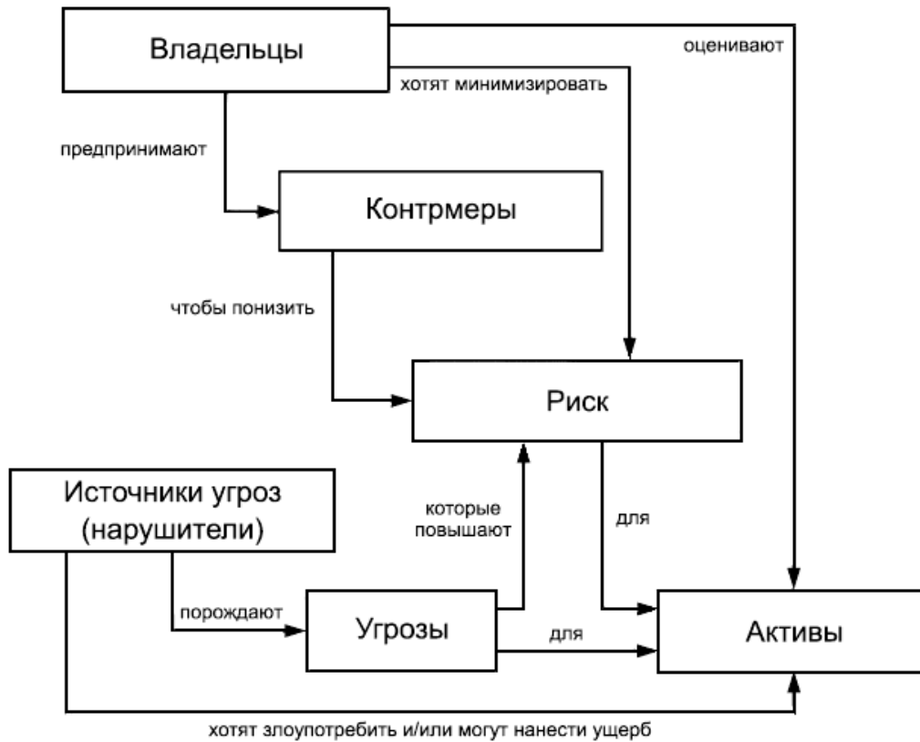
Рис.2. Понятия кибербезопасности в контексте риск-ориентированного подхода защиты владельцев активов предприятий Источник: Стандарт ГОСТ Р ИСО/МЭК 15408-1-2012 [5]
