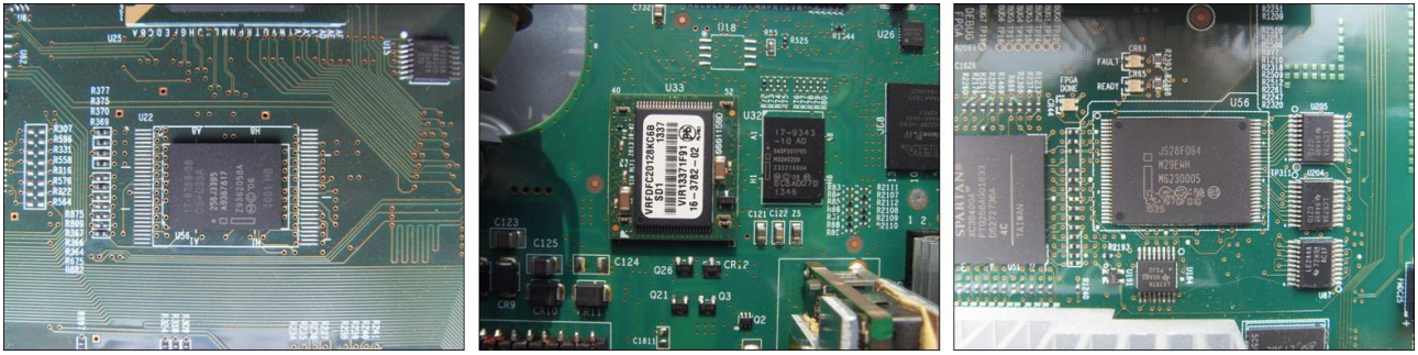
Рисунок 5.10 – On-board flash (не только подсистема памяти Flash) 2960 (BootROM плюс NVRAM плюс Flash), 3560-X (BootROM плюс NVRAM плюс Flash, в двух разных микросхемах), 3650 (BootROM) соответственно (те же модели)
