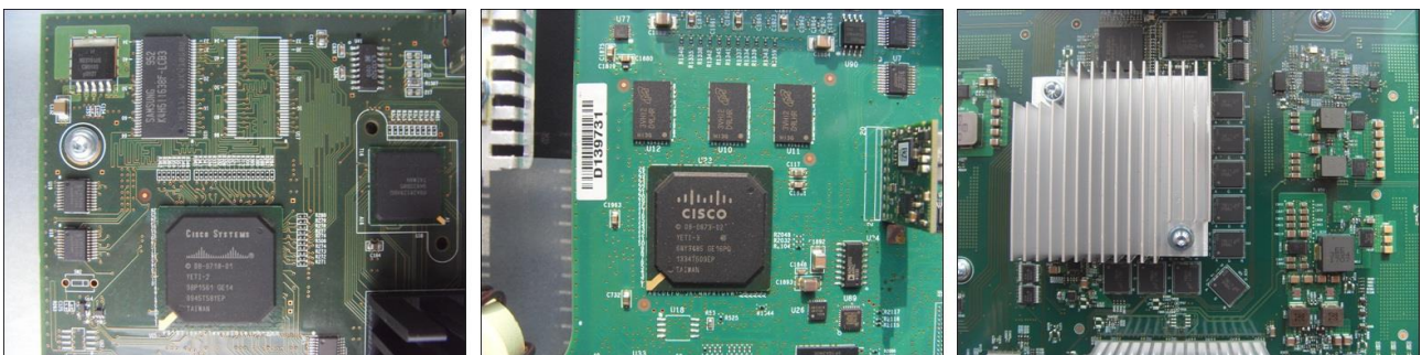
Рисунок 5.9 – Процессоры и DRAM 2960, 3560-X, 3650 соответственно (те же модели)
