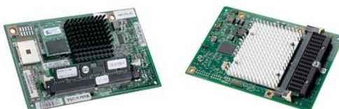
Рисунок 1.5 – AIM-IPS-K9, ISM-VPN-29 соответственно [Cisco]
