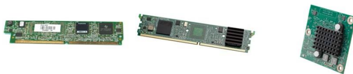
Рисунок 1.6 – PVDM2-32, PVDM3-128, PVDM4-256 соответственно [Cisco]
