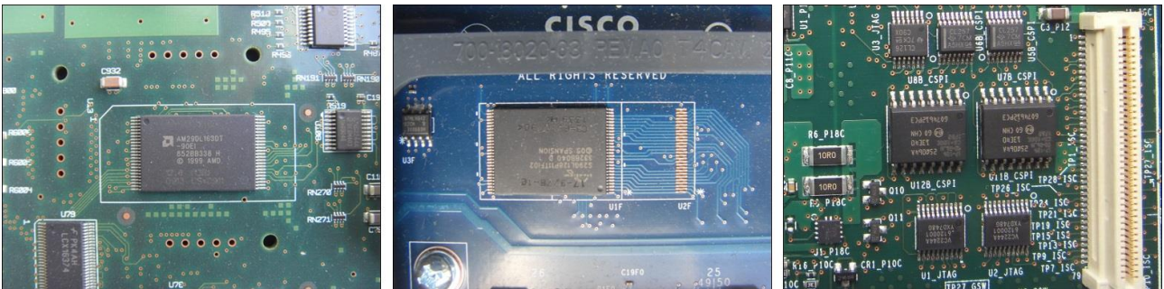
Рисунок 1.16 – On-board flash (не подсистема памяти Flash) 2811 (BootROM плюс NVRAM), 2901 (BootROM плюс NVRAM), 4331 (BootROM в двух микросхемах) соответственно
