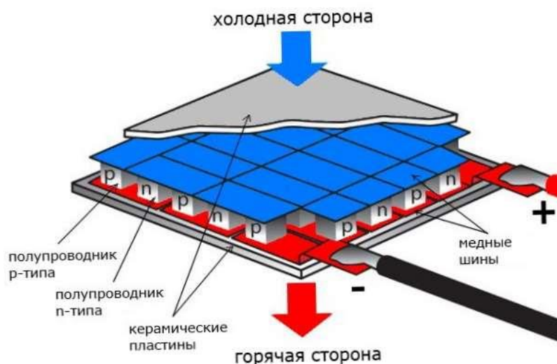
Рисунок 2 – Принцип работы модуля Пельтье
