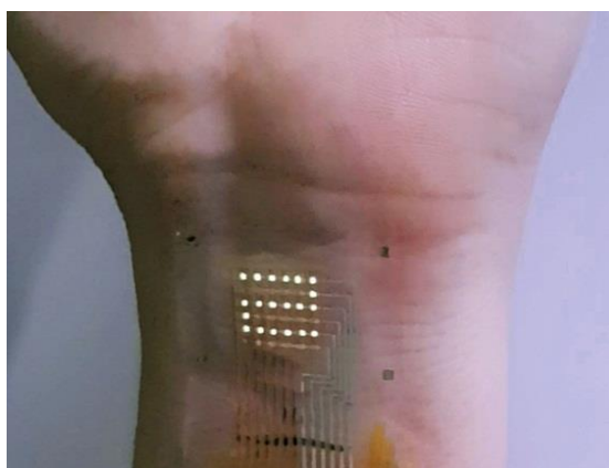
Рисунок 1 – Изображение гибкого транзистора на основе дисульфида молибдена на пластиковой подложке на руке человека
