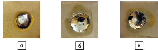
Рис. 7. Образцы растекаемости пасты на серебряном 0,6-мкм покрытии с процентным содержанием УНТ: а) 0,01%; б) 0,02%; в) 0,03%
