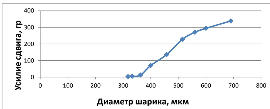
Рис. 2. Зависимость усилия сдвига шариков припоя от их диаметра
