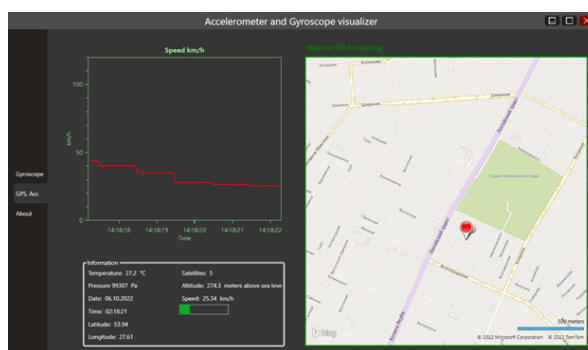
Рис. 3 – Пример работы акселерометра и гироскопа
