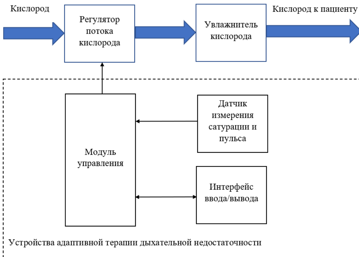
Рисунок 1. Структурная схема устройства адаптивной терапии дыхательной недостаточности
