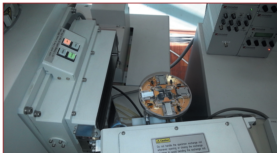
Рис. 5. Загрузка зондодержателя в РЭМ S-4800
