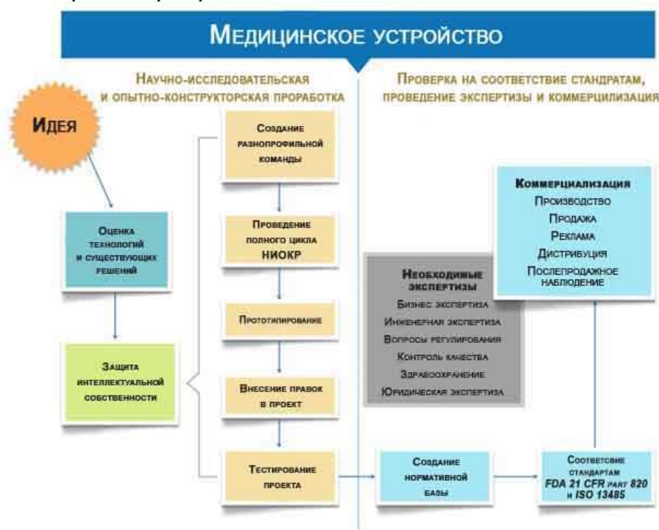
Рис. 1. Последовательность действий при проектировании нового медицинского устройства
