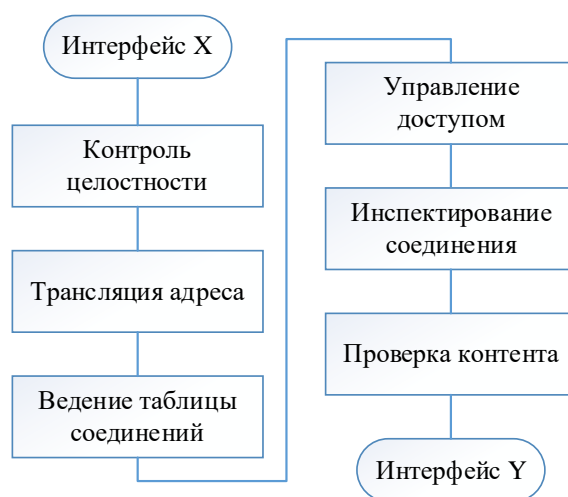
Рисунок 2.1 – Последовательность функций анализа пакета в МСЭ
