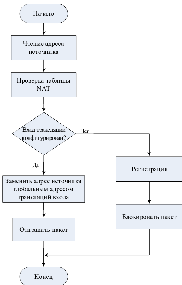
Рисунок 2.5 – Алгоритм трансляции внутреннего адреса источника статическим методом
