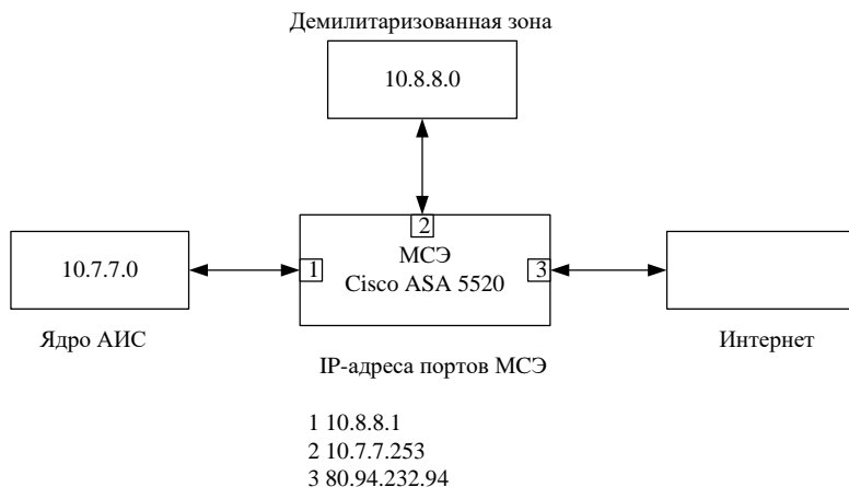
Рисунок 3.4 – Схема подключения устройств к МСЭ
