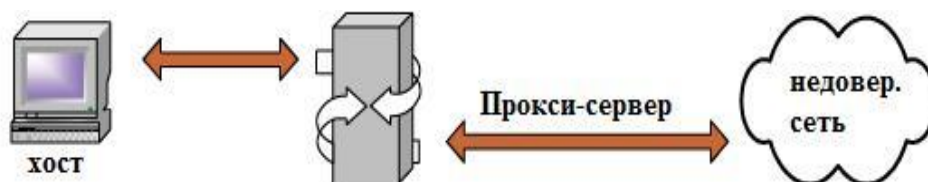
Рисунок 1.6 – Прокси-сервер межсетевое экрана
