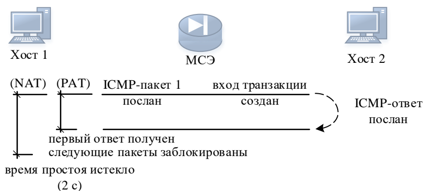
Рисунок 2.13 – Прохождение ICMP-трафика через МСЭ
