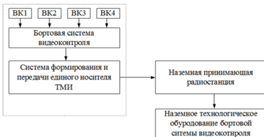
Рис. 1. Обобщенная структурная схема взаимодействия составных частей БСВК
