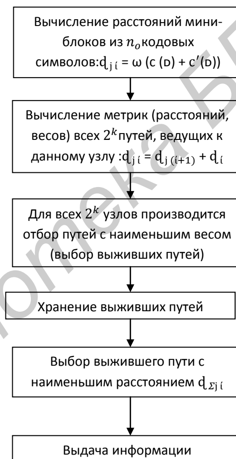
Рис. 1.11. Блок-схема алгоритма декодирования Витерби
