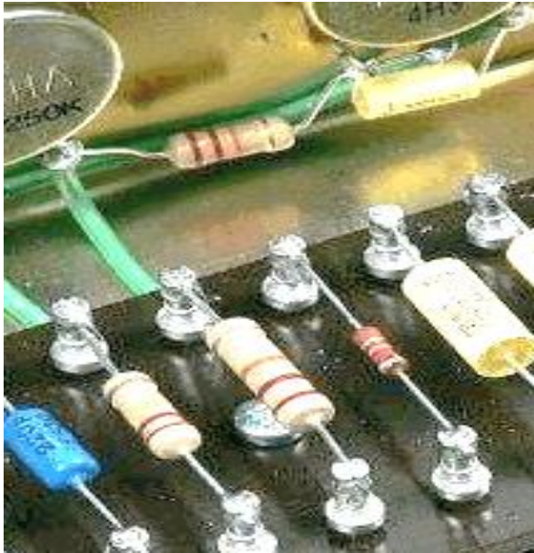
Рисунок 3.2 – Навесной монтаж резисторов
