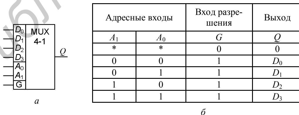
Рис. 4.1. 4-канальный мультиплексор (а) и таблица функционирования (б)
