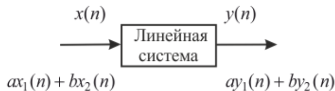
Рис. 2.1. Схема линейной системы
