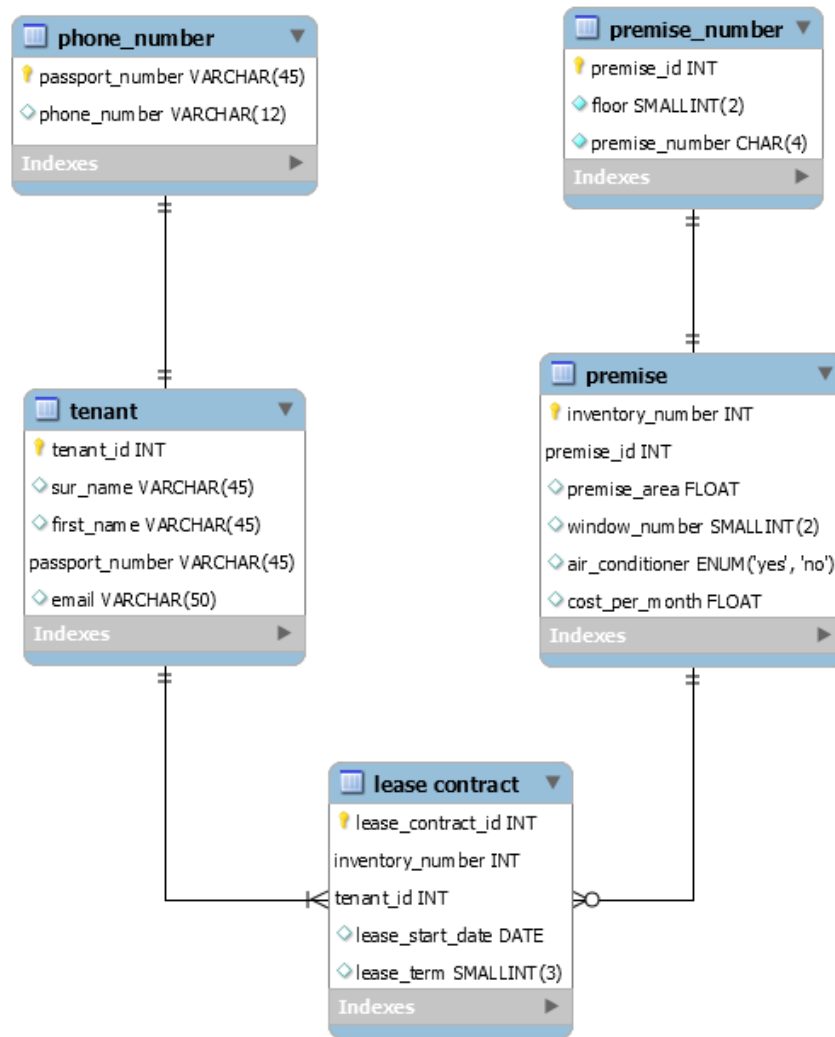
Рисунок 14 – Физическая схема БД
