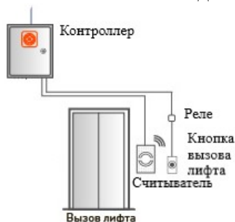
Рисунок 1 – Схема ограничения доступа к лифту на этапе его вызова
