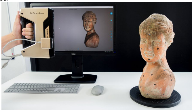
Рисунок 2 – Принцип работы лазерного 3D-сканера [5]
