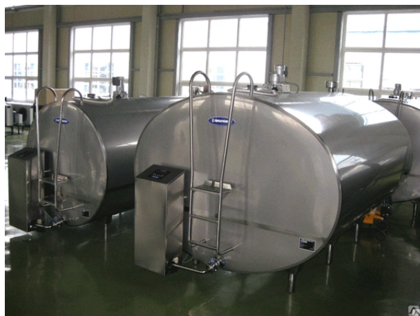
Рисунок 1. Установка охлаждения молока МОУ-4000Г со схемой управления электроприводом на основе преобразователя частоты для электропривода компрессора
