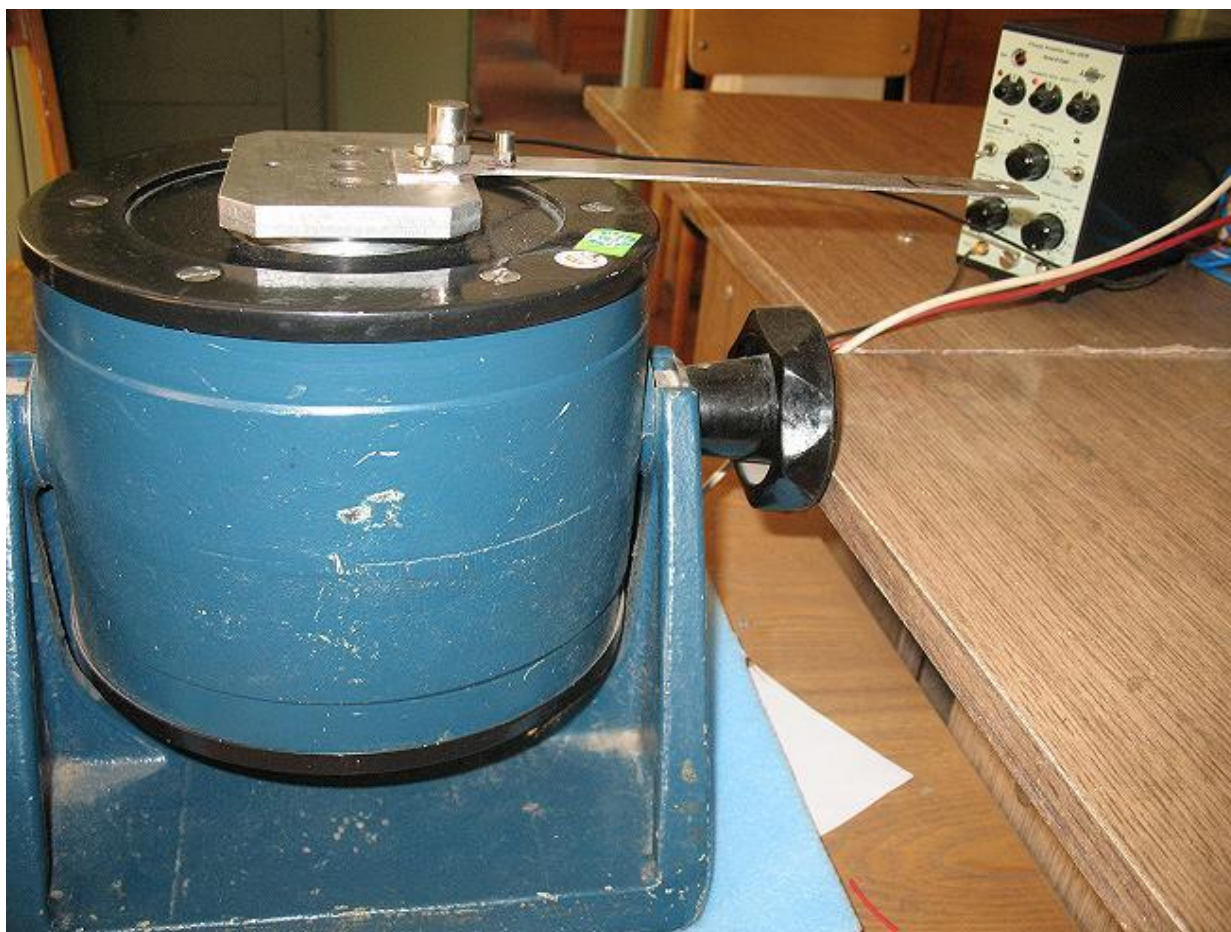
Рисунок 4.2 – Вибростенд ROBOTRON 11077 и согласующий усилитель 2635 датской фирмы Брюль и Кьер
