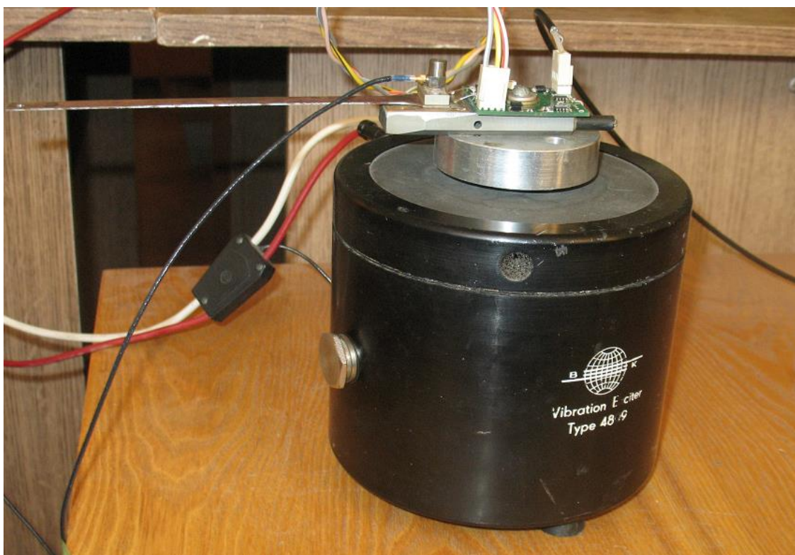
Рисунок 4.6 – Крепление балки из стали при применении емкостного датчика, изготовленного в комплекте с согласующим усилителем
