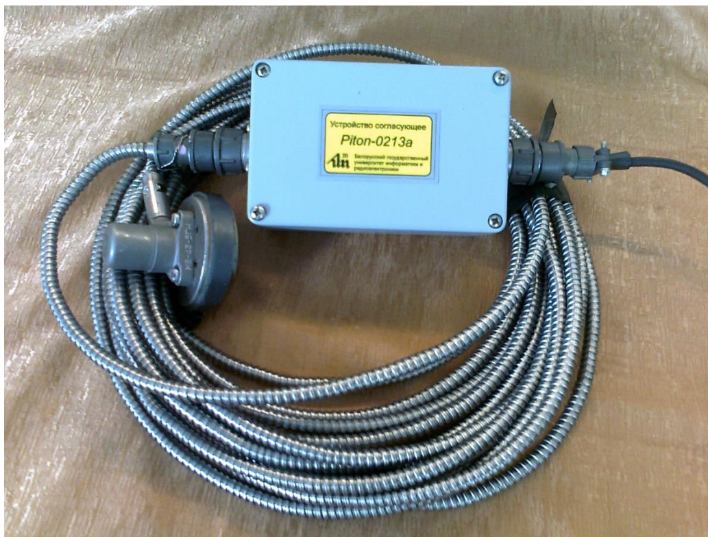
Рисунок 5.1 – Первичный виброизмерительный преобразователь и согласующий усилитель
