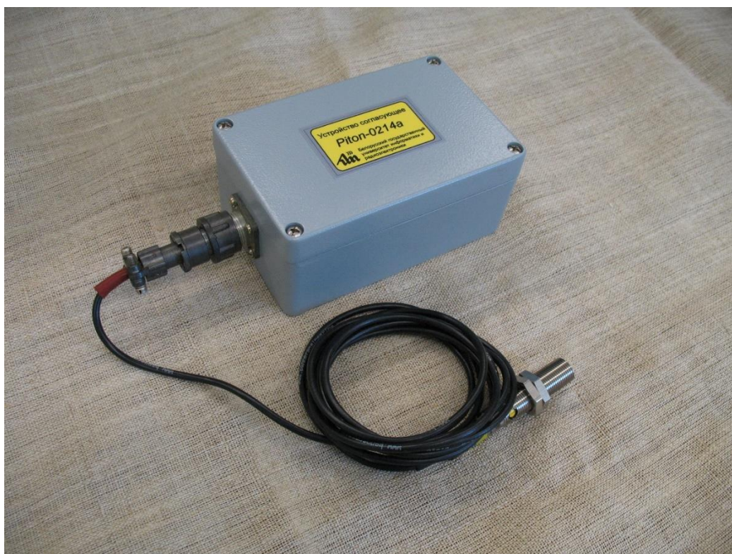
Рисунок 5.2 – Датчик фазовой метки и согласующий усилитель
