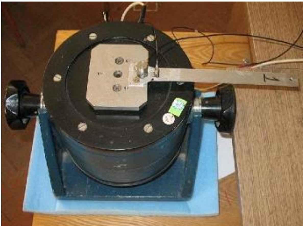
Рисунок 4.5 – Крепление балки и установка ВИП при проведении испытаний балки из дюралюминия
