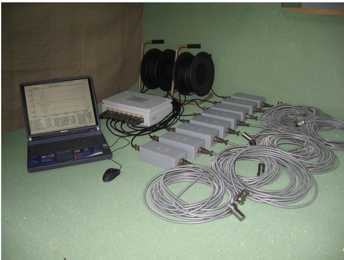
Рисунок 5.18 – ИВК «Тембр» для непрерывной регистрации вибрационных сигналов
