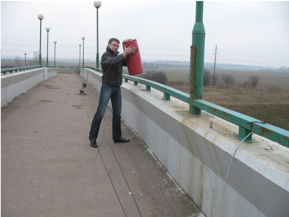
Рисунок 5.20 – Воспроизведение динамического воздействия при определении собственных частот конструкций пешеходного перехода
