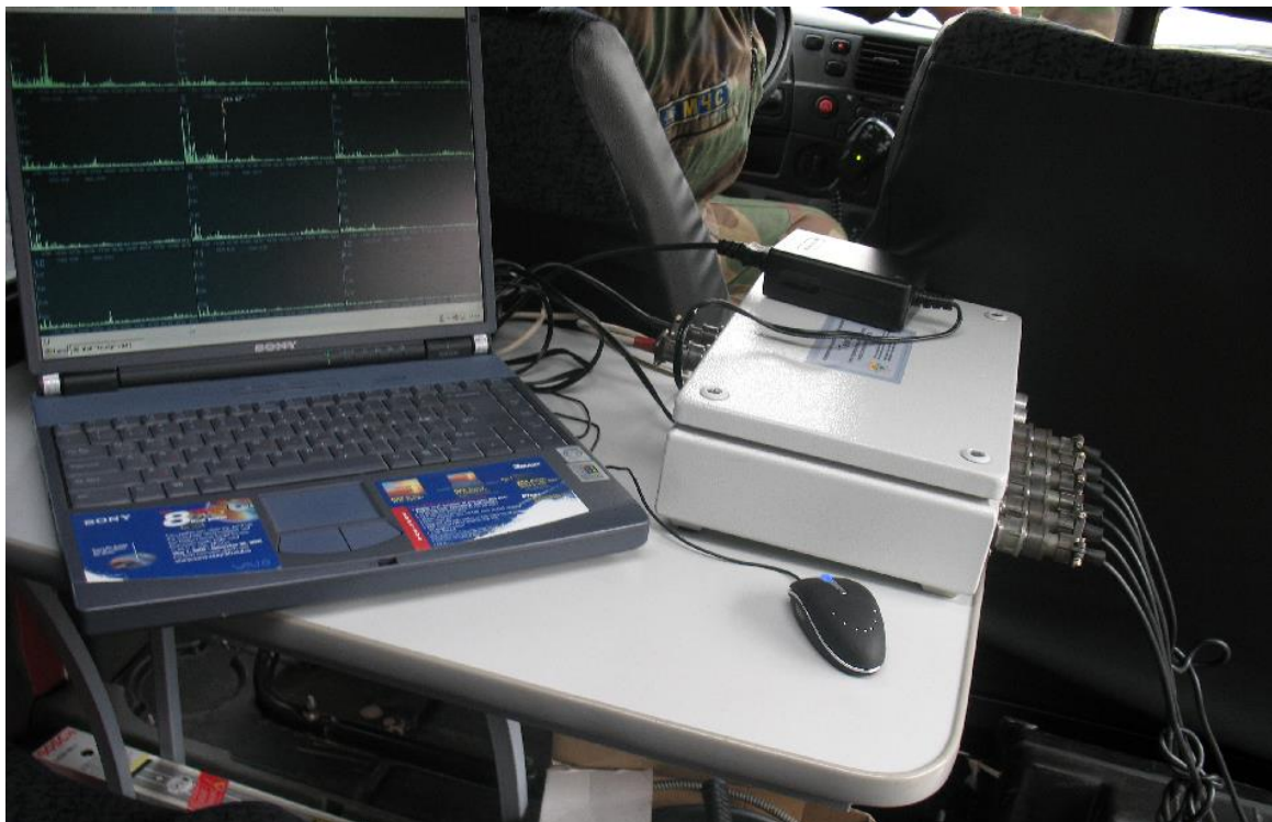
Рисунок 5.21 – Регистрация вибрационных сигналов при определении собственных частот конструкций пешеходного перехода методом динамического воздействия
