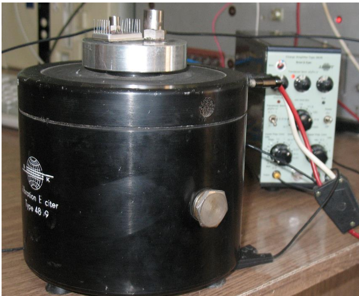
Рисунок 4.3 – Вибростенд 4809 датской фирмы Брюль и Къер
