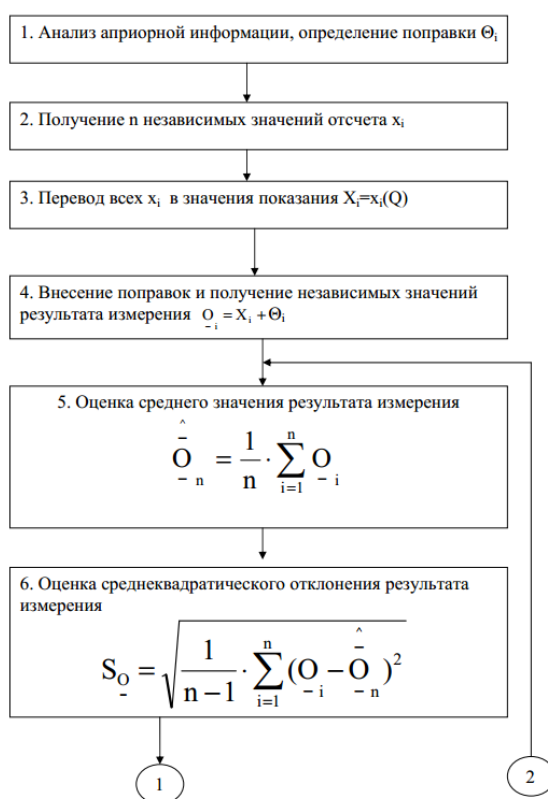
Рисунок 1 – Порядок выполнения многократного измерения при равноточечных значениях отсчета
