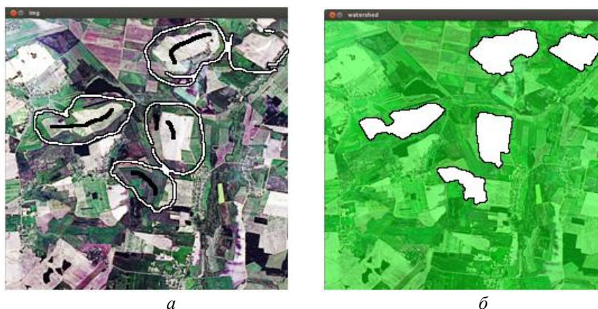
Рис. 2. Результаты сегментации земель с помощью алгоритма Watershed: а – разметка изображения маркерами; б – результат работы алгоритма с выделенными полями
