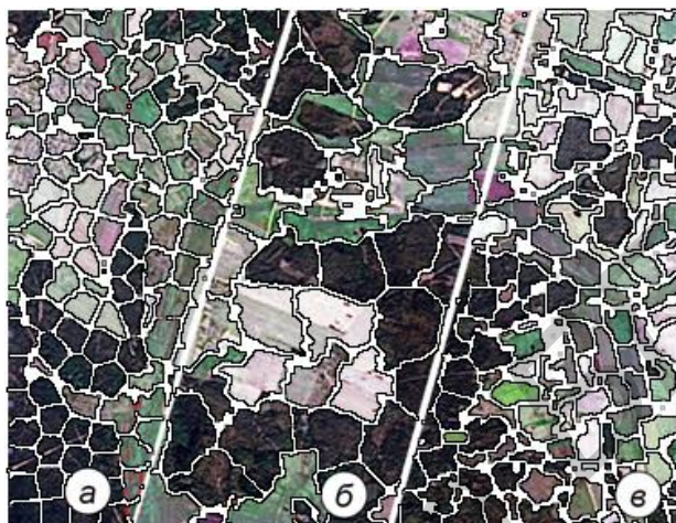
Рис. 4. Результаты разбиения снимка на суперпиксели с использованием алгоритма SLIC с различными параметрами: a - S_z = 32, Reg = 4 ; б - S_z = 64, Reg = 4 ; в - S_z = 32, Reg = 2
