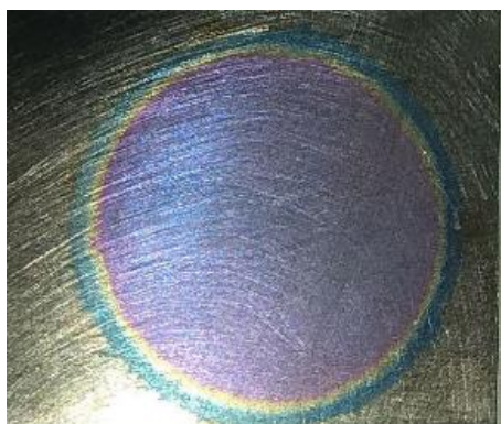
Рис. 2. Оксидная пленка на обработанной механическим путем поверхности титана, полученная в 5% растворе хлорида натрия и оксидная пленка на поверхности титана, полученная в 0,1% растворе хлорида натрия
