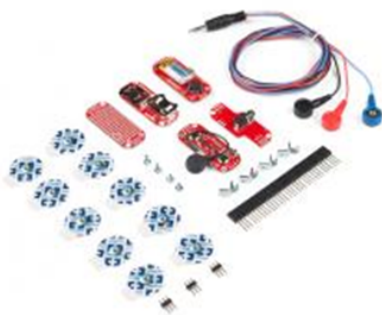
Рисунок 9. Внешний вид датчика MyoWare
