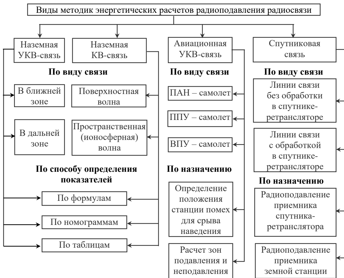
Рис. 25. Классификация методик энергетических расчетов возможности радиоподавления радиосвязи
