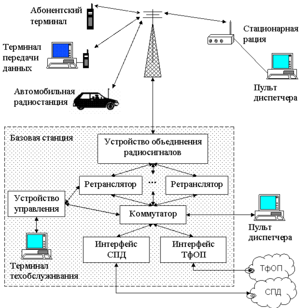
Рис. 16. Структурная схема однозонавой транкинговой системы
