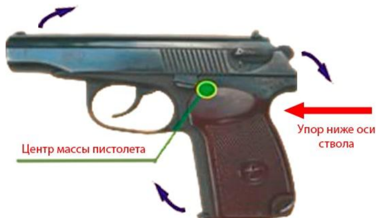
Рисунок 4 – Сила проворачивания пистолета вокруг центра масс
