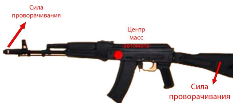
Рисунок 17 – Сила проворачивания автомата вокруг центра масс
