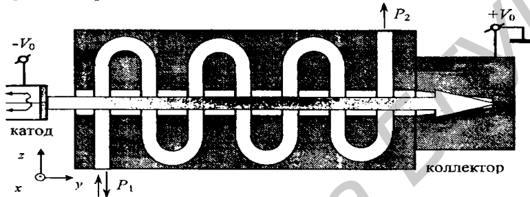
Рисунок 1 – Схема ЛБВ на волнообразно изогнутом волноводе
