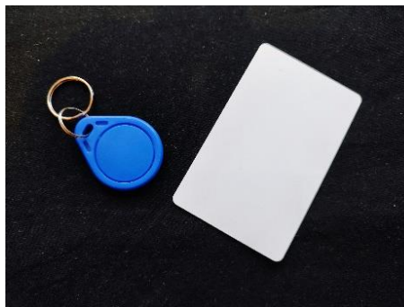
Рисунок 2 – Примеры пассивных RFID-меток
