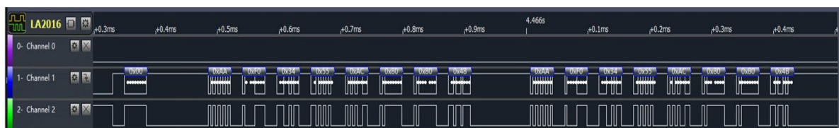
Рисунок 2 – Передача данных от контроллера к LED-панели
